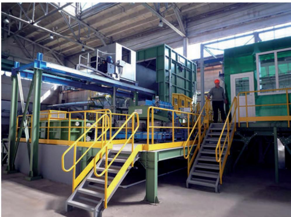
*Линия горячего цинкования метизов*
